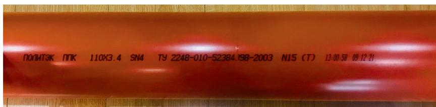
Рис. 1. Труба ППК 110x3,4 SN 4, производитель — ООО «Политек», дата изготовления 09.12.2021 г. (продавец — магазин «Леруа Мерлен»)
