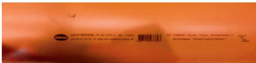
Рис. 5. Труба UNIVERSAL PP 110x3,4 SN 4, производитель — ООО «СИНИКОН», дата изготовления 09.09.2021 г. (продавец — магазин «Сатурн»)
