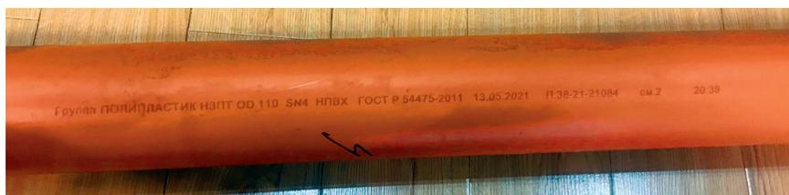
Рис. 2. Труба OD 110 SN 4 НПВХ, производитель — НЗПТ (ООО «Группа ПОЛИПЛАСТИК»), партия № 38-21-21084, дата изготовления 13.05.2021 г. (продавец — магазин «Сантехкомплект»)
