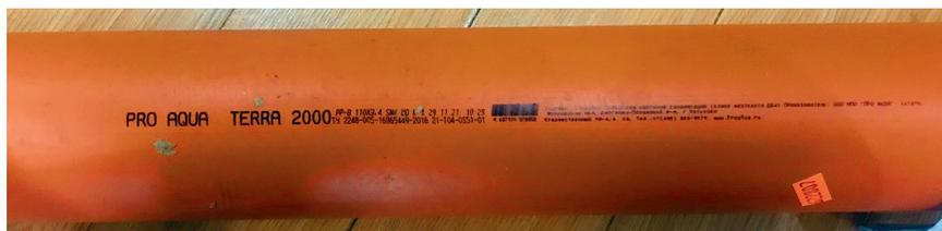
Рис. 3. Труба PRO AQUA TERRA 2000 PP-B 110x3,4 SN 4, производитель — ООО НПО «Про Аква», дата изготовления 29.11.2021 г. (продавец — магазин «Лунда»)
