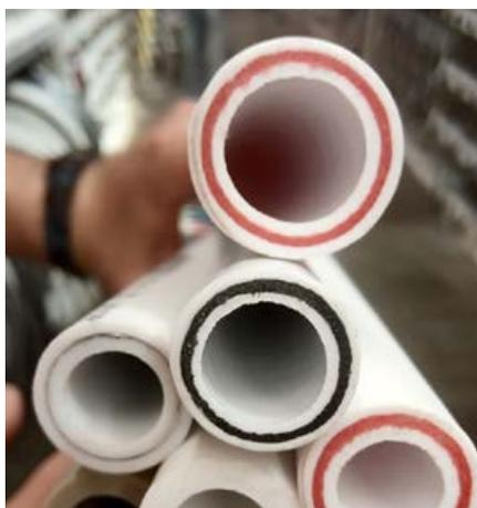
Определить наличие гомополимера можно по температуре плавления. Рандом-сополимеры плавятся при температуре в диапазоне 140–150°C, а температура плавления гомополимера составляет более 160°C. Таким образом, если температура плавления среднего слоя превышает 150°C, это говорит о примеси гомополимера в его составе.
