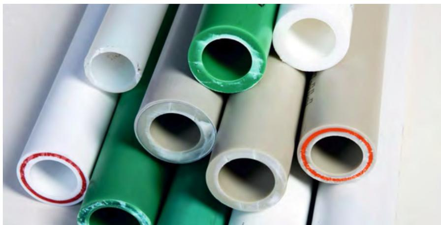
Однако появившаяся труба с армировкой стекловолокном, не требующая зачистки, но пропускающая кислород и поэтому недопустимая к использованию в системах отопления, при применении маркировки PN25 также соответствует по названию «армированная PP-RC труба PN25». Этот парадокс «убивает» трубу STABI и системы отопления в России.
