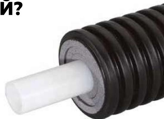
Трубы ИЗОПРОФЛЕКС-95А, ИЗОЛА ТА-95 и ТВЭЛ-ПЭКС-К отличаются от предыдущих армированием напорной трубы. Напорная труба в них изготовлена из сшитого полистирила PE-Xa, армирована нитями из высокомодульного волокна. Параметры эксплуатации: 95°C и 1,0 МПа.
