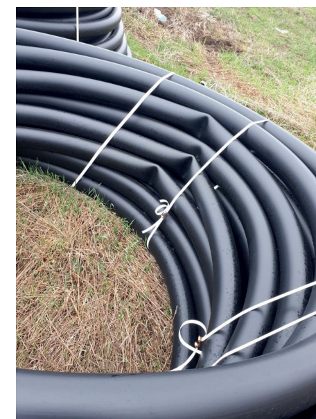
Рис. 2. Пример фальсифицированной продукции — деформация трубы с потерей устойчивости
