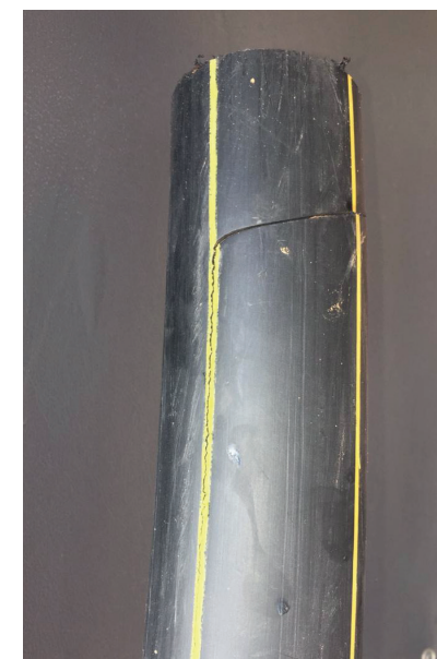
Рис. 1. Растрескивание некачественной трубы для газопровода при пневмоиспытаниях
