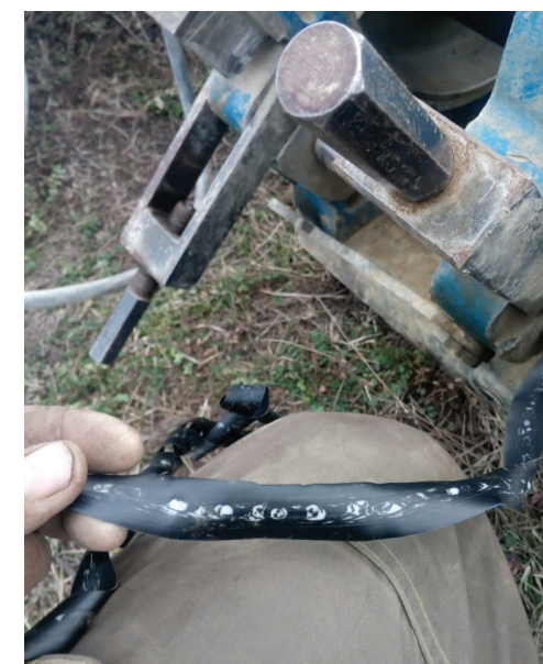
Рис. 3. Пример стружки фальсифицированной трубы с вкраплениями не трубного полиэтилена
