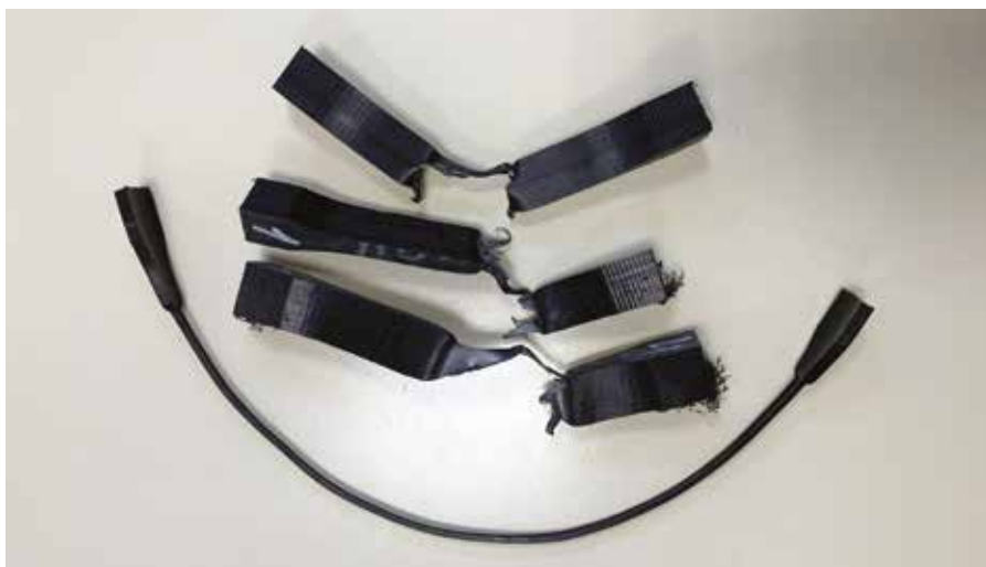
Рис. 1. Образцы труб после испытания на относительное удлинение при разрыве: фальсификат (вверху) и качественная труба (снизу). Разница очевидна
