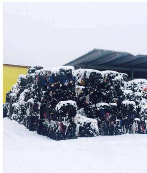
*Вторичное полиэтиленовое сырье можно использовать для производства тары, кровельных материалов, канистр и других изделий. Но не для производства напорных труб!*
