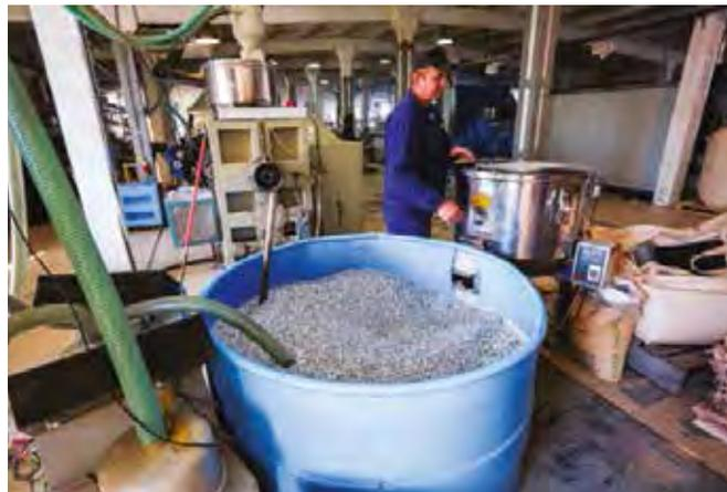
**Рис. 1** Некоторые производители не скрывают, что производят трубу из суррогатного сырья (фото с сайта [www.primpolimer.ru](http://www.primpolimer.ru))
