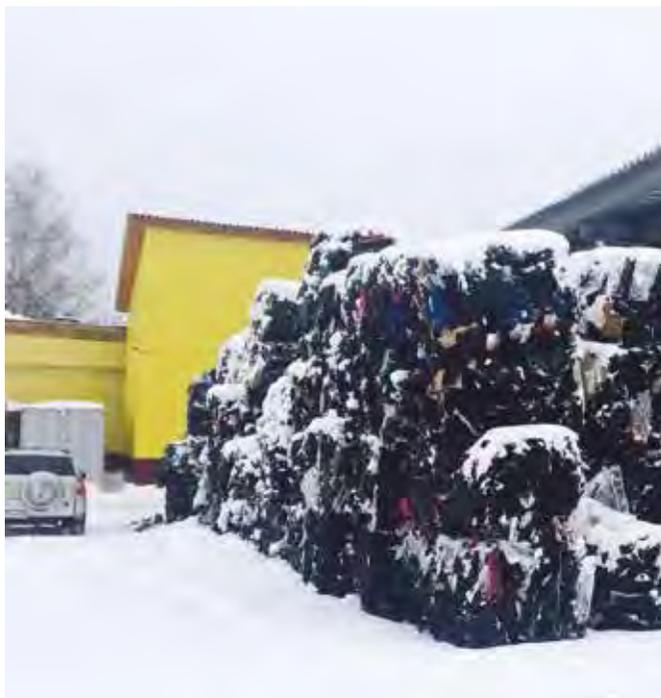
**Рис. 2** Вторичное полиэтиленовое сырье можно использовать для производства тары, кровельных материалов, канистр и других изделий. Но не для производства напорных труб! (Фото сделано на Ногинском заводе полимерных материалов)
