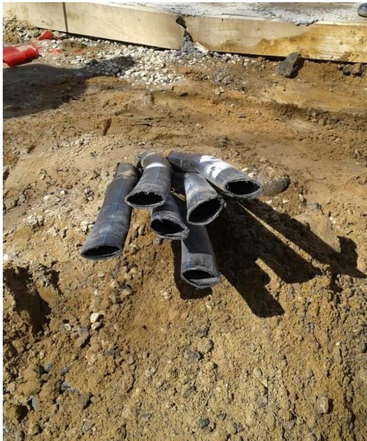
Серьезные последствия при эксплуатации (сплющивание труб)
