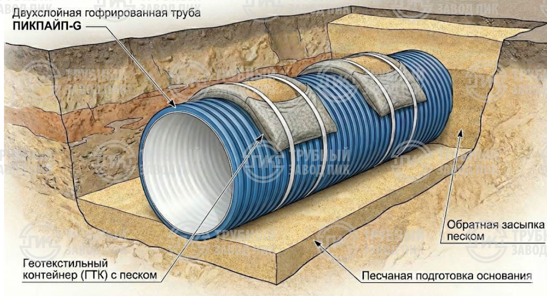
Рисунок 6.1 Установка геотекстильных контейнеров
