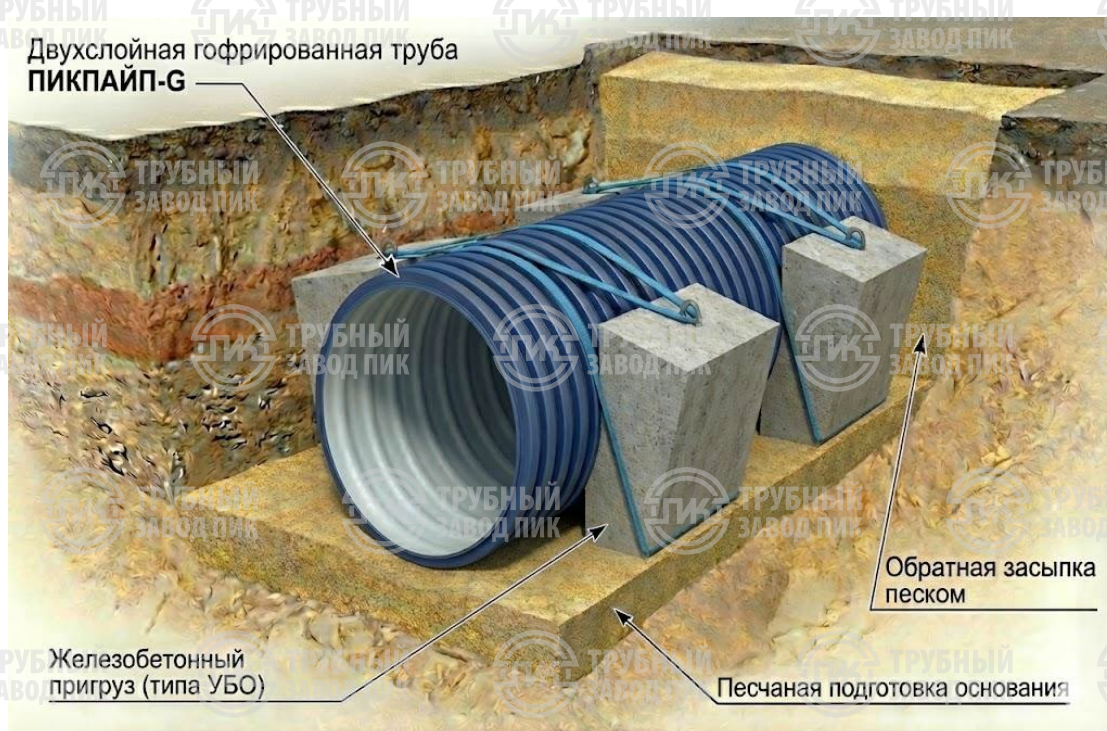
Рисунок 6.3. Установка железобетонных утяжелителей типа УБО
