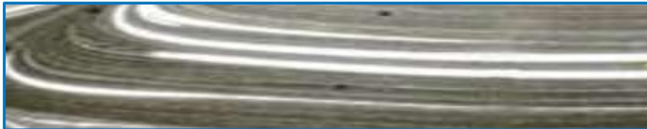
*\*Увеличение среза фальс. ПЭ трубы толщиной 0,3мм под микроскопом*
