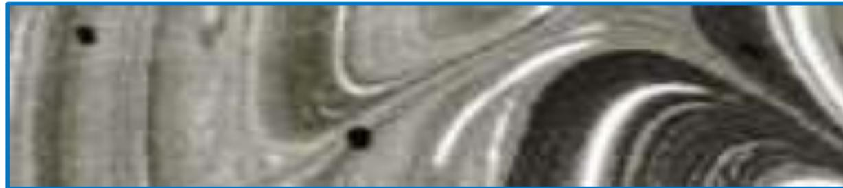
*\*Увеличение среза фальс. ПЭ трубы толщиной 0,5мм под микроскопом*
